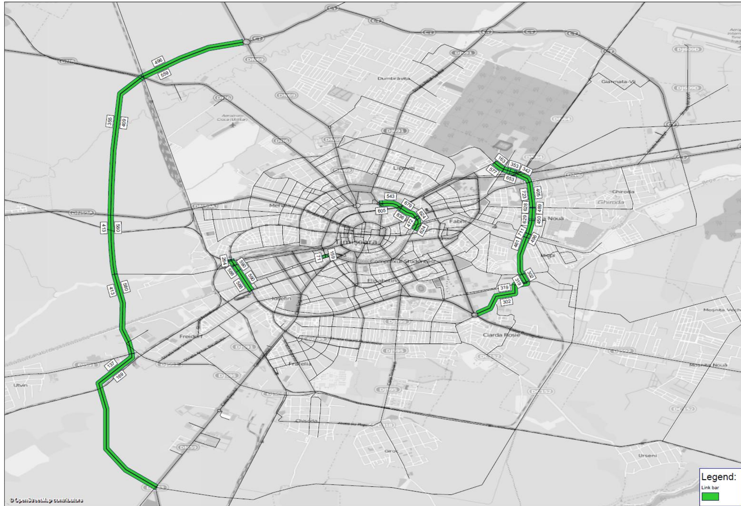
Figura 64 – Fluxurile de vehicule pe drumurile noi propuse în 2030, la ora de vârf de dimineață (08.00-09.00) – ScA 3
