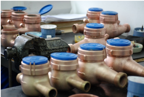
Foto: Contoarele de apă, verificate în programul de scadență metrologică
